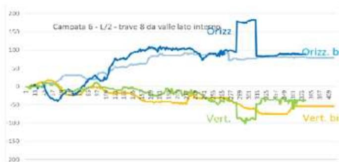
Figura 20-5: Esempio di output con lettura in continua di dati che legge la lettura del transito di un mezzo pesante durante l'esecuzione della prova
